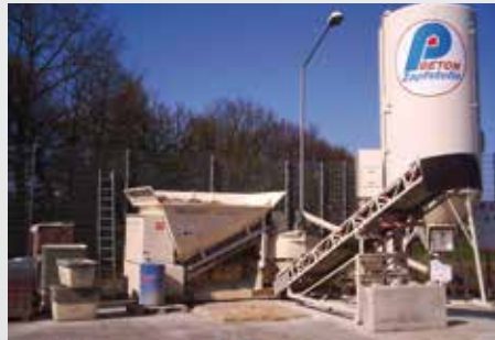
*1 Zementsilo (35 t, V: 27,3 m 3 , H: 7,50 m) · *2 Abluftfilter (17 m 2 ) + Zementförderschnecke ·
