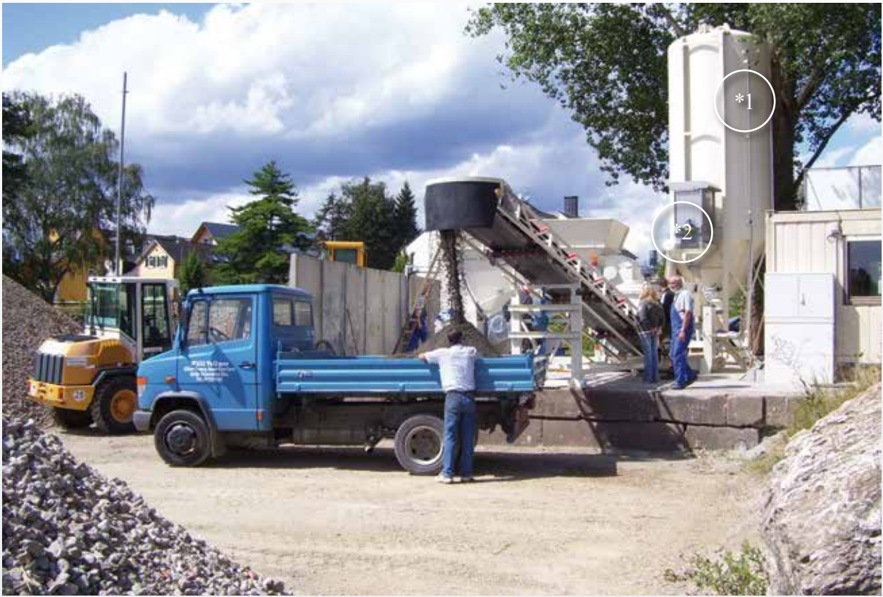
*1 Zementsilo (35 t, V: 27,3 m 3 , H: 7,50 m) · *2 Abluftfilter (17 m 2 ) + Zementförderschnecke ·
