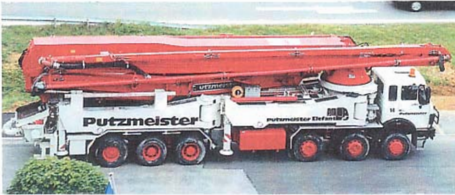
Die Putzmeister Großmast-Betonpumpe M 62-5 zeichnete sich bereits 1986 durch ihren großen Arbeitsbereich, einen baustellengerechten „Fünflings“-Mast, hohe Pumpleistung und äußerst kompakte Abmessungen aus.
