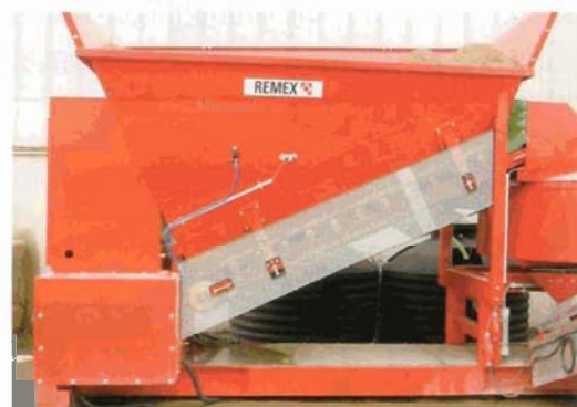
Die Kammern für die Zuschlagstoffe fassen ausreichend Material für die Mischung von 4 bis 5 m³ Frischbeton.
